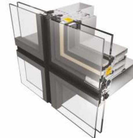
Silikon Cephe sistemi son yıllarda sıkılıkla tercih edilen cephe çözümüdür. Camlar, ısicam çitasının bulunduğu kısımlardan özel klipsler yardımıyla düşey ve yatay ana profiller üzerine sabitlenir ve camlar arası derzler silikon ile doldurularak kapatılır. Alternatif olarak geliştirilmiş ekonomik bir çözümüdür.
