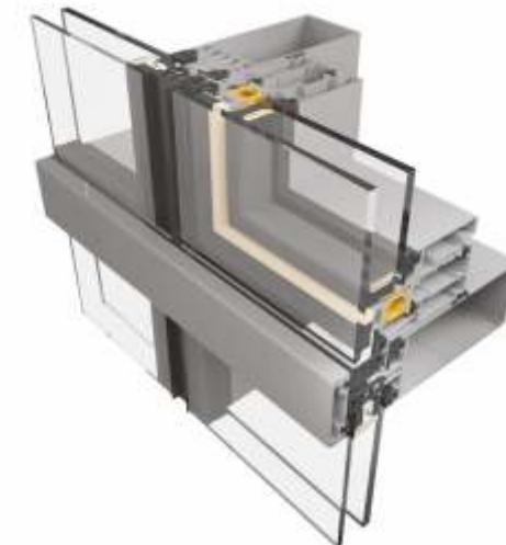
Cam, yatay veya düşey olarak yalnızca bir eksende baskı profili ile dıştan sabitlenir. Diğer eksende ise cephe çözümüne bağlı olarak klipsler ile düşey ve yatay ana profillere sabitlenir. Çoğunlukla, yapıya yatay veya düşey etki vermek için tercih edilir. Badem formlu, kutu kesitli, klasik kapak profili vb. birçok farklı kapak alternatifi ile çalışılabilir.
