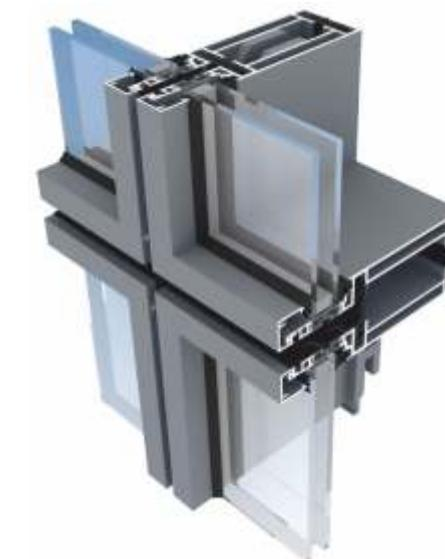
Panel cephe çözümleri, çubuk (stick) cephelerden farklı olarak tamamen fabrika ortamında hazırlanan, camlı alüminyum panellerin betonarme döşemeye özel ankrajlar ile asılması ile oluşturulmaktadır. Çubuk cephelere kıyasla daha az montaj personeline ihtiyaç duyulmakta ve daha kısa sürede montaj tamamlanmaktadır. Bununla birlikte, fabrikasyon aşamasının daha maliyetli olması ve sistem detaylarının çokluğu, cephenin binaya montajı öncesi uzun bir hazırlık süreci gerektirir.
